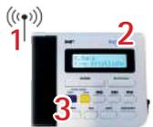
1. Antenne vollständig ausziehen und gerade stellen
